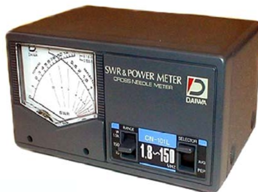
Slika 2. SWR-power metar DAIWA model CN-101L je odličan. On ima "crossneedle" sistem i istovremeno pokazuje i snagu i SWR. Veoma je tačan u merenju snage kada su u pitanju kratkotalasne frekvencije, čak je bolji od nekih veoma skupih naprava koje se nisu baš proslavile u uporednom testu.
