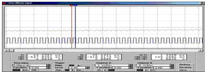
Slika 8. Signal smetnji pri otporu prekidača 5\Omega i S=3,18\mu F i otpora signala 50\Omega
