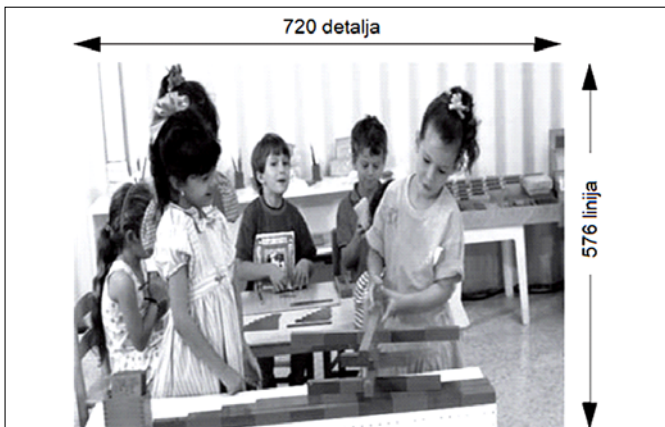
Slika 16. Prikaz slike formata 16:9 na prijemu formata 12:9 izdužena po visini, sabijenasa strane ( Squazed mode )
